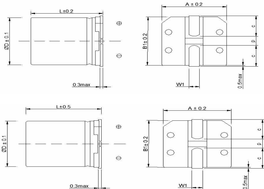
注：L=5.5mm L±0.2; L=7.7mm L±0.3; L=10.5~12.5mm L±0.5
